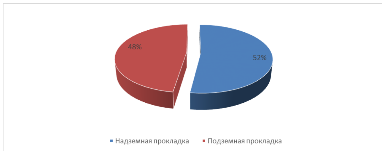
Рисунок 3.5 – Распределение протяженности трубопроводов магистральных тепловых сетей по типу прокладки
